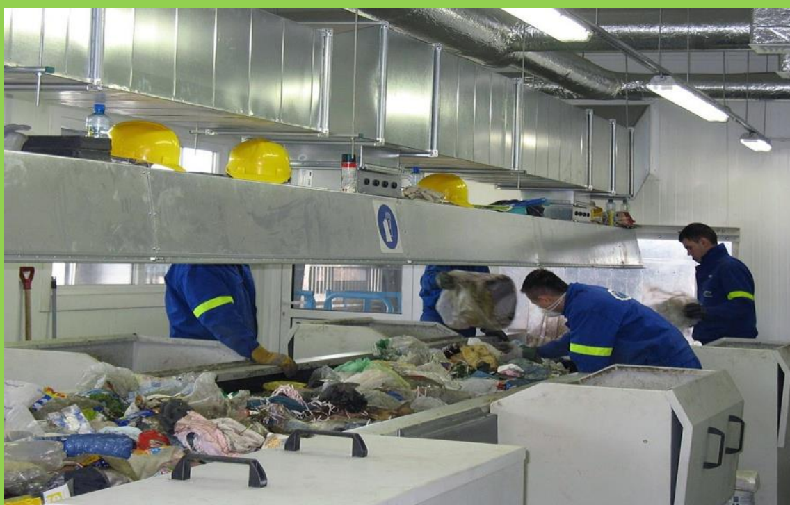
Stanowiska pracownicze przy linii sortowniczej ZZO
